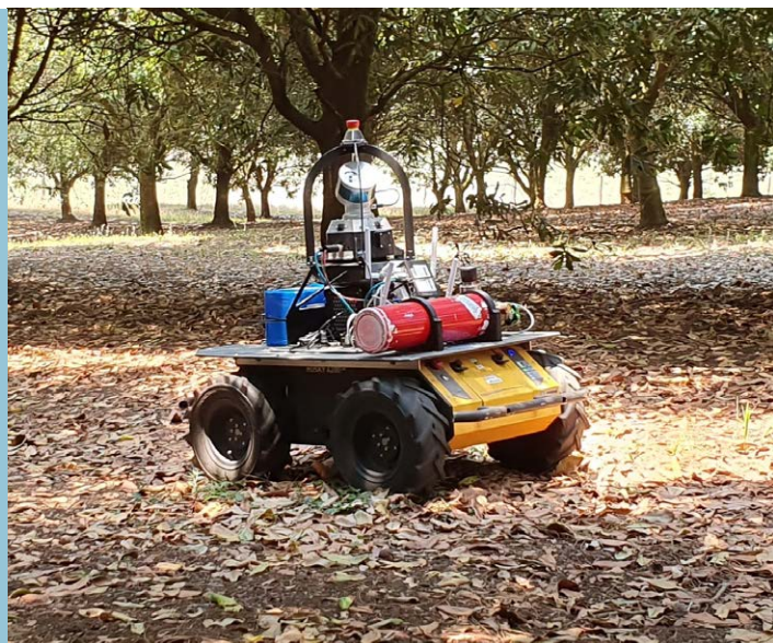
Drone terrestre basé sur la plateforme « Husky » et équipé d'un système de propulsion hybride, fruit d'un projet sur la sécurité énergétique lancé dans le cadre du programme de l'OTAN pour la science au service de la paix et de la sécurité. Australie, novembre 2020.
